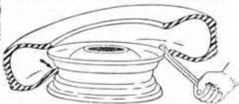
Фиг. 120. Демонтаж покрышки.
