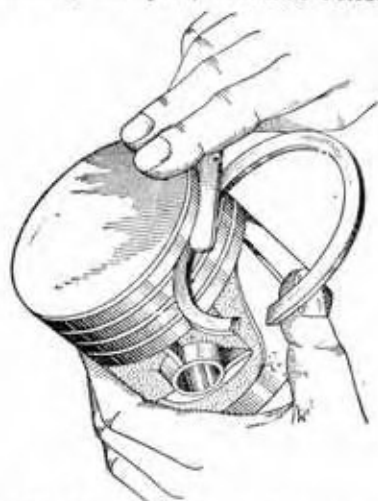
Фиг. 15. Проверка зазора между поршневым кольцом и канавками поршня.
