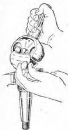
Фиг. 84. Положение кулаков шарнира, в котором устанавливается последний шарик.
