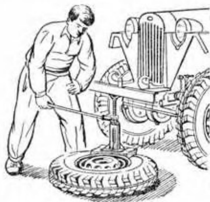
Фиг. 119. Устранение прилипания покрышки.
