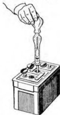
Фиг. 62. Проверка удельного веса электролита.
