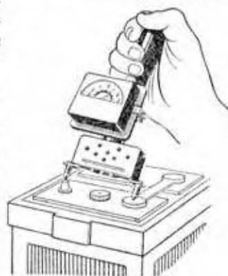
Фиг. 63. Проверка исправности аккумуляторной батареи нагрузочной вилкой.
